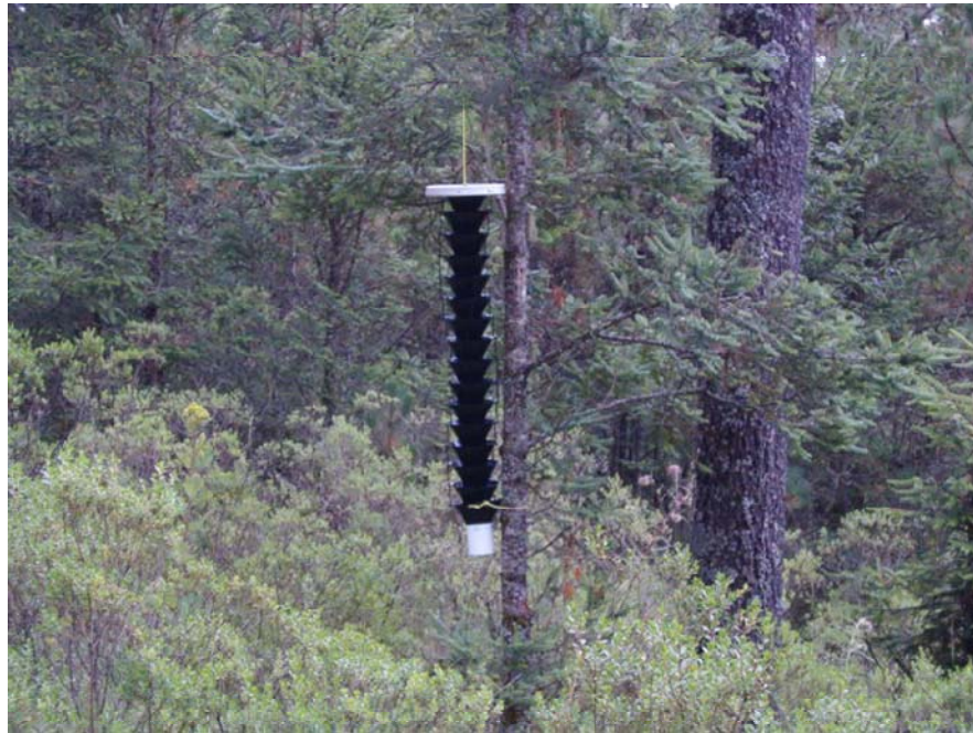
Figura 7. Colocación de trampas tipo Lindgren cebadas con frontalina en Los Pescados, Municipio de Perote, Veracruz.
