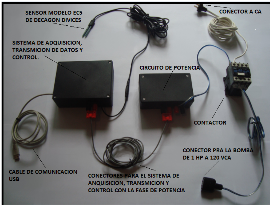
Figura 4.20. Sistema de adquisición, transmisión de datos y control, con sus componentes electrónicos y eléctricos.
