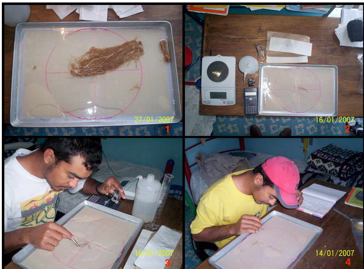
1. Superficie plana con cuadrícula de 0.5 cm por lado, en donde se extienden las raíces. 2. Instrumentos para medir raíces (balanza analítica, contador de mano, probeta graduada, piceta, pinzas saca-cejas, toallas absorbentes etc.). 3 y 4. Forma de ejecutar el método.
