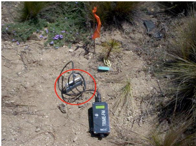
Figura 4.10. Mediciones de humedad del suelo para los tratamientos RS y CC.
